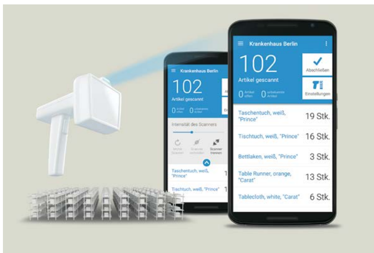
Mit dem Smartphone kann direkt beim Kunden vor Ort gescannt werden. Via Bluetooth stellt das Smartphone automatisch eine Verbindung zum RFID-Scanner her.
