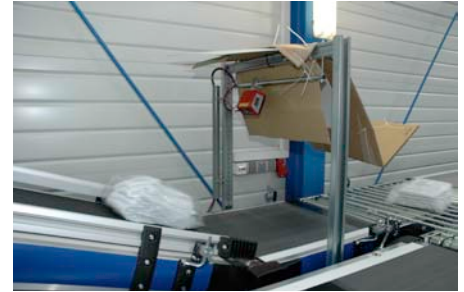
Die Reader arbeiten schnell und zuverlässig. Vor zusätzlichen Licht müssen sie geschützt werden. Das wird hier noch professionell nachgeholt.
