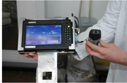
Die mobilen Terminals zur Auftragsabwicklung werden an den Container angehängt und erleichtern das Kommissionieren.
