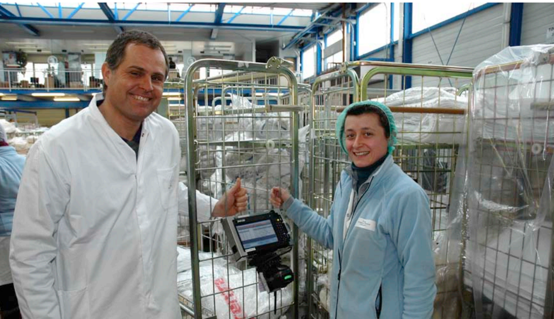
Für die Kommissionierung wird der Auftrag vom Büro auf ein mobiles Terminal übertragen. Beim Packen des Containers scannt die Mitarbeiterin die Ware.
